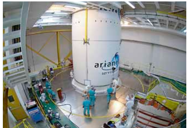
Oben: Schließen der Ariane-5-Oberstufe nach Satellitenintegration Unten: Satellitenintegration in die Raketenoberstufe bei Arianespace in Kourou
