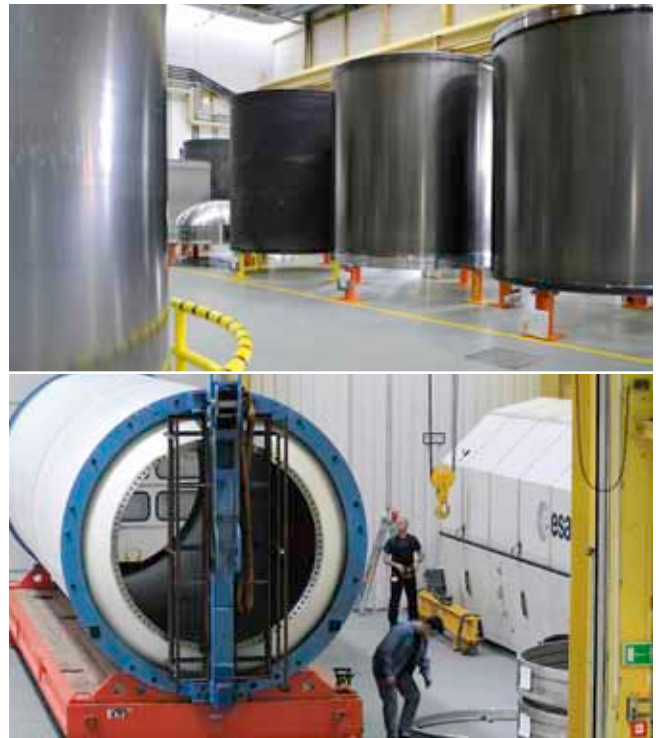
Produktion von Ariane-5-Boostercases bei MT Aerospace in Augsburg
